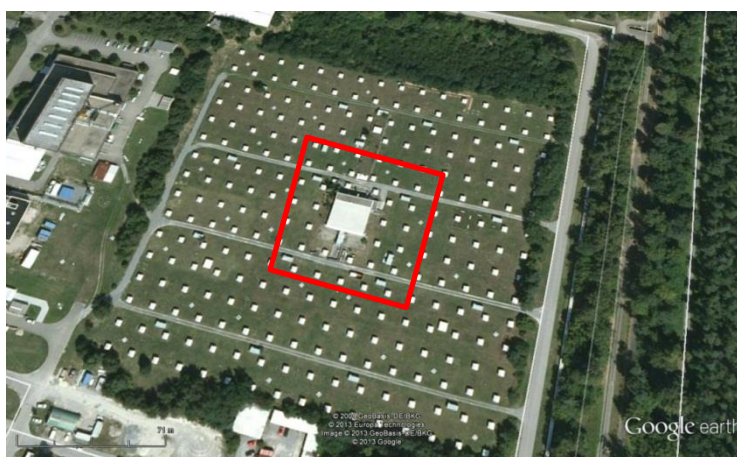
Figura 3.3 Amplasarea stațiilor de detecție care formează rețeaua KASCADE (un cluster delimitat cu contur roșu).
